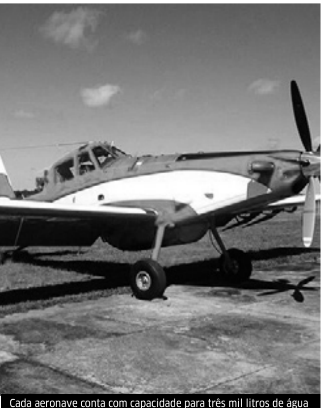
Cada aeronave conta com capacidade para três mil litros de água
